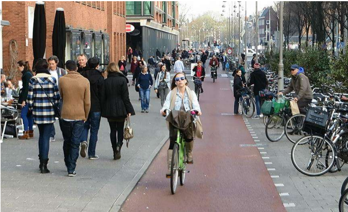
Figura 2. Exemplo de Amsterdão (foto da web) em que se distingue pavimentos dedicados ao peão e ao ciclista, através de ligeira diferença de cota e de contraste cromático.
